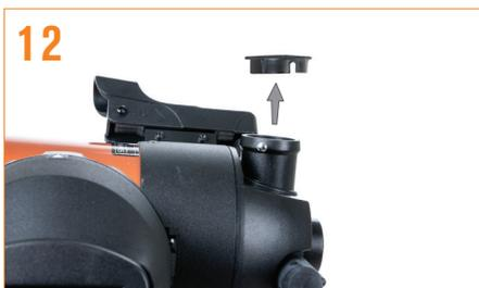
Per il modello NexStar 4SE, il diagonale stellare è integrato nella cella posteriore del telescopio. Rimuovere semplicemente il tappo dal supporto per oculare.
