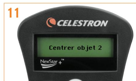
11 Pour le second objet d'alignement, choisissez une étoile brillante ou une planète aussi éloignée que possible du premier objet d'alignement. Encore une fois, utilisez les touches fléchées pour centrer l'objet dans le chercheur et appuyez sur ENTRER. Une fois l'objet centré dans l'oculaire, appuyez sur ALIGNER.
