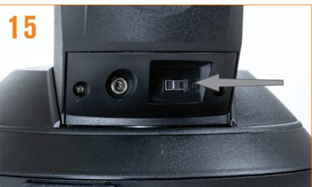
Encienda el interruptor de encendido situado en la base del brazo de horquilla.
