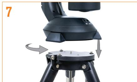
7 Coloque la base del telescopio sobre el cabezal del trípode de forma que el agujero del centro de la base de montaje se alinee con la punta de posicionamiento en la parte superior del trípode. Gire el soporte del telescopio de forma que las 3 patas de goma se alineen con los 3 tornillos de montaje que sobresalen de la placa de montaje del trípode.
