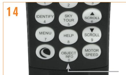
14 Appuyez sur le bouton INFO OBJET (bouton 0 du pavé numérique) pour lire les informations sur l'objet affiché. Appuyez sur le bouton DÉFILEMENT vers le bas pour afficher l'objet suivant de la liste. Appuyez sur ENTRER pour automatiquement orienter le télescope sur la cible sélectionnée.
