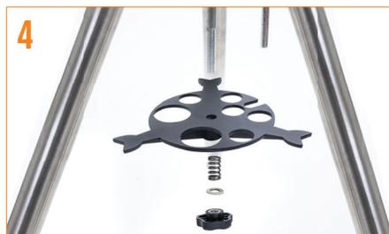
4 L'asta di regolazione della latitudine passa attraverso la fessura del vassoio. Far scorrere il vassoio porta-accessori sull'asta filettata in modo che ciascun braccio del vassoio spinga contro ciascuna gamba del treppiede. Posizionare nuovamente e serrare la manopola di blocco del supporto per le gambe per fissare il vassoio in posizione.
