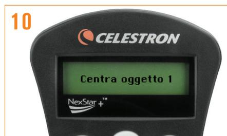
Il comando manuale richiede di centrare la stella di allineamento al centro dell'oculare. Una volta centrato, premere ALIGN (ALLINEA). Ciò accetterà la stella come prima posizione di allineamento. I motori rallentano automaticamente per semplificare ciò.
