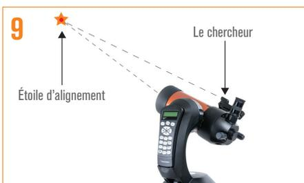
9 Si le chercheur a été correctement aligné, alors l'étoile d'alignement sera maintenant visible dans le champ de vision de l'oculaire.
