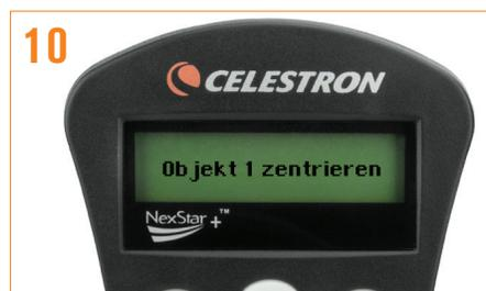
Die Handsteuerung fordert Sie auf, den hellen Ausrichtungstern in der Mitte des Okulars zu zentrieren. Sobald er zentriert ist, drücken Sie ALIGN (AUSRICHTEN). Dadurch wird der Stern als Ihre erste Ausrichtungsposition übernommen. Um dies zu erleichtern, drehen sich die Motoren automatisch langsamer.
