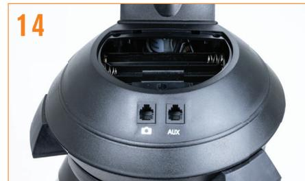
Entfernen Sie die Batterieabdeckung von der Mitte des Sockels, indem Sie den runden Teil der Abdeckung vorsichtig anheben. Legen Sie 8 AA-Batterien in das Batteriefach ein und bringen Sie die Batteriefachabdeckung wieder an. Achten Sie beim Einlegen der Batterien auf die richtige Polarität.
