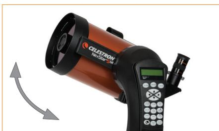
Con il telescopio acceso, utilizzare i pulsanti direzionali del comando manuale (tasti freccia) per spostare il telescopio su, giù, a sinistra e a destra. L'asse dell'altitudine (su e giù) ha inoltre una frizione antisaltellamento che può essere spostata manualmente a mano in qualsiasi momento. L'asse azimut (sinistra e destra) non ne è provvisto. Forzare il telescopio a sinistra e destra senza utilizzare il comando manuale può causare danni agli ingranaggi.
