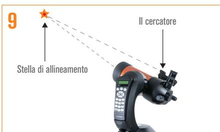
Se il cercatore è stato correttamente allineato, la stella di allineamento dovrebbe ora essere visibile all'interno del campo visivo dell'oculare.
