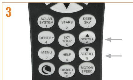
Utilisez les boutons DÉFILEMENT vers le haut et vers le bas (situés respectivement sur les touches #6 et #9) pour sélectionner « SkyAlign », puis appuyez sur ENTRER.
