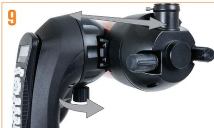
Para ajustar el equilibrio o sacar el tubo de la base, afloje el mando de la fijación de liberación rápida y deslice el tubo hacia la célula posterior de éste. Aguante firmemente el tubo al montar o desmontar y asegúrese de que la fijación machihembra esté apretada antes de soltar el tubo.
