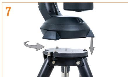
7 Setzen Sie den Sockel des Teleskops auf den Stativkopf, sodass das Loch in der Mitte des Montagesockels mit dem Positionierstift oben auf dem Stativ ausgerichtet ist. Drehen Sie die Teleskopmontierung so, dass die 3 Gummifüße mit den 3 Befestigungsschrauben, die aus der Stativ-Montageplatte herausragen, ausgerichtet sind.
