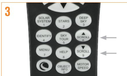
**3** Verwenden Sie die Bildlauf Tasten „Nach oben“ und „Nach unten“ (sie befinden sich auf Taste Nr. 6 und 9), um „SkyAlign“ auszuwählen. Drücken Sie dann ENTER (EINGABE).
