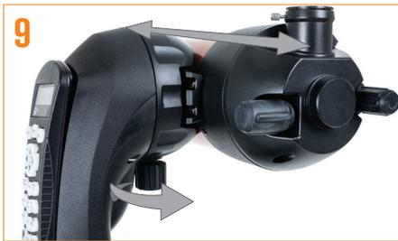
Um den Tubus zu justieren oder von dem Sockel zu entfernen, lösen Sie einfach den Schnellspann-Klemmknopf und schieben Sie den Tubus zurück in Richtung der hinteren Zelle des Tubus. Halten Sie den Tubus bei der Montage oder Demontage fest und vergewissern Sie sich, dass die Schwalbenschwanzklemme fest sitzt, bevor Sie den Tubus loslassen.
