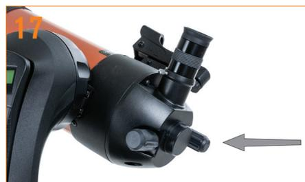
Per ottenere una visione ottimale attraverso il telescopio, ruotare lentamente la manopola di messa a fuoco fino a quando gli oggetti sono a fuoco.
