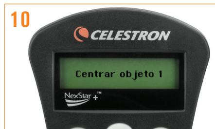
10 El mando manual le solicitará que centre la estrella de alineación brillante en el ocular. Cuando haya terminado, pulse ALINEAR. Hacerlo aceptará la estrella como primera posición de alineación. Los motores se ralentizarán automáticamente para facilitararlo.
