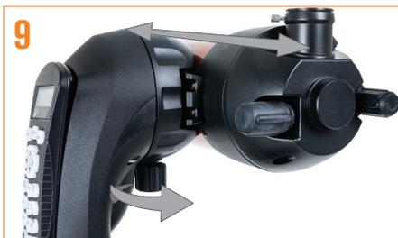
Per regolare l'equilibrio o rimuovere il tubo dalla base, allentare semplicemente la manopola del fermo a rilascio rapido e fare scorrere il tubo indietro verso la cella posteriore del tubo. Tenere saldamente il tubo durante il montaggio e lo smontaggio e assicurarsi che il fermo a coda di rondine sia serrato prima di lasciare andare il tubo.
