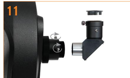
Para NexStar 5SE, saque la tapa de la parte posterior del telescopio. Introduzca el cañón plateado de la diagonal estelar en la parte posterior visual como se muestra anteriormente. Apriete el tornillo plateado para asegurarlo.
