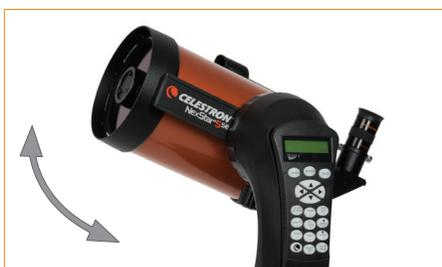
Avec le télescope sous tension, utilisez les boutons directionnels de la commande manuelle (les touches fléchées) pour déplacer la lunette vers le haut, le bas, la gauche ou la droite. L'axe d'altitude (haut et bas) est équipé d'un levier de frein et peut être déplacé manuellement à tout moment. L'axe d'azimut (gauche et droite) ne le permet pas. Forcer la lunette à gauche et à droite sans utiliser la commande manuelle peut endommager les engrenages.
