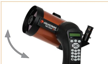
Verwenden Sie bei eingeschaltetem Teleskop die Handsteuerungstasten (Pfeiltasten), um das Teleskop nach oben, unten, links oder rechts zu bewegen. Die Höhenachse (nach oben und unten) hat auch eine Rutschkupplung, die Sie jederzeit von Hand bewegen können. Die Azimutachse (nach links und rechts) besitzt keine. Wenn Sie das Teleskop manuell nach links oder rechts schwenken, ohne die Handsteuerung zu verwenden, kann dies zu Schäden an den Getrieben führen.
