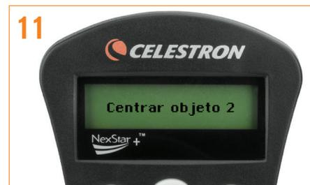
11 Para el segundo objeto de alineación, elija una estrella o planeta brillante lo más lejano posible del primer objeto de alineación. Use de nuevo los botones de flecha direccional para centrar el objeto en el localizador y pulse ENTER. Cuando el objeto esté centrado en el ocular, pulse ALINEAR.
