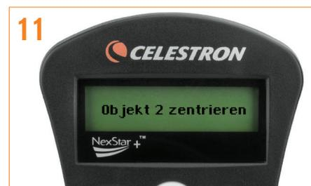
Wählen Sie als zweites Ausrichtungsobjekt einen hellen Stern oder Planeten so weit wie möglich vom ersten Ausrichtungsobjekt entfernt. Verwenden Sie erneut die Richtungspfeiltasten, um das Objekt im Sucherfernrohr zu zentrieren und drücken Sie ENTER (EINGABE). Sobald das Objekt im Okular zentriert ist, drücken Sie ALIGN (AUSRICHTEN).
