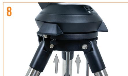
8 Serrare i bulloni di montaggio imperdibili sotto la testa del treppiede per fissare la montatura al treppiede.
