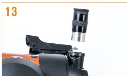
. Inserire il barilotto argentato dell'oculare da 25mm nel diagonale stellare o nel supporto per oculare sul NexStar 4SE. Serrare la vite argentata per fissare.
