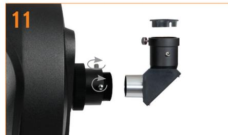
Per NexStar 5SE, rimuovere il tappo dalla parte posteriore del telescopio. Inserire il barilotto argentato del diagonale stellare nel visual back come mostrato sopra. Serrare la vite di regolazione argentata per fissare.
