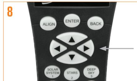
8 La monture est maintenant prête à être alignée. Utilisez les flèches de direction sur le contrôle à main pour orienter (déplacer) le télescope vers un objet céleste brillant. Centrez l'objet dans le chercheur et appuyez sur le bouton ENTRER. Pendant l'alignement, ne déplacez pas la lunette ni le trépied à la main. Utilisez uniquement la commande pour orienter la lunette, sous peine d'introduire des erreurs.
