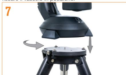
7 Sistemare la base del telescopio sulla testa del treppiede in modo che il foro al centro della base della montatura sia allineato con il perno di posizionamento in cima al treppiede. Ruotare la montatura del telescopio in modo che i 3 piedini in gomma siano allineati con le 3 viti di montaggio che protendono dalla piattaforma di montaggio del treppiede.
