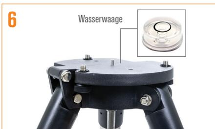
6 Legen Sie die Wasserwaage auf das Stativ, um zu prüfen, ob es waagrecht steht. Passen Sie die Höhe der einzelnen Beine bei Bedarf vorsichtig an und überprüfen Sie dann wieder mit der Wasserwaage. Entfernen Sie die Wasserwaage, wenn Sie fertig sind.
