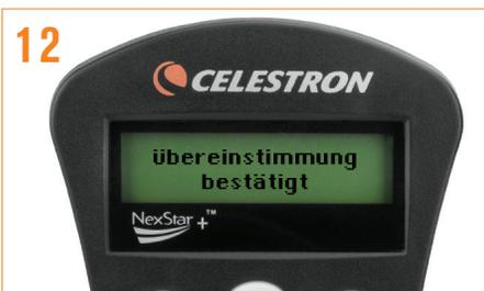
Wiederholen Sie den Vorgang für den dritten Ausrichtungstern. Wenn das Teleskop auf den letzten Stern ausgerichtet wurde, wird auf dem Display „Match Confirmed“ (Übereinstimmung bestätigt) angezeigt. Drücken Sie die Taste UNDO (ZURÜCK), um die Namen der drei hellen Ausrichtungsobjekte anzuzeigen oder drücken Sie ENTER (EINGABE), um diese drei Objekte zum Ausrichten anzunehmen.
