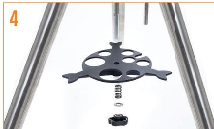
4 Die Breitengradeinstellstange wird durch den Ausschnitt in der Ablage geführt. Schieben Sie die Zubehörablage so auf die Gewindestange, dass jeder Arm der Ablage an jedem Stativbein anliegt. Setzen Sie den Feststellknopf der Beinstrebe wieder ein und ziehen Sie ihn fest, um die Ablage zu sichern.
