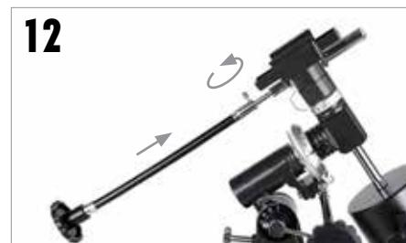
12 Schieben Sie das verchromte Ende der Zeitlupen-Kontrollkabel auf die Getriebewelle der äquatorialen Montierung. Achten Sie darauf, dass die Stellschraube über der flachen Stelle auf der Welle ausgerichtet ist. Ziehen Sie die Schraube fest, um sie zu sichern.
