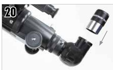
20 Entfernen Sie die Kappe und setzen das 20-mm-Okular in den Zenitspiegel ein und ziehen die Stellschraube fest.
