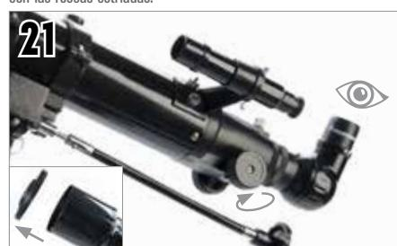
Saque la tapa de la lente de la parte anterior del telescopio. Para observar, mire por el ocular como se indica anteriormente. Enfoque la imagen girando los mandos bajo el enfoque.
