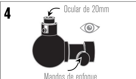
Mire por el ocular de 20mm del telescopio. Gire suavemente los mandos de enfoque para ajustar la definición de la imagen.
