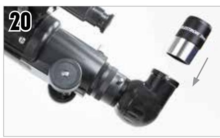
Rimuovere il tappo, inserire l'oculare da 20mm nella diagonale e serrare la vite di regolazione.
