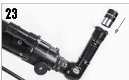
Ensuite, insérez l'oculaire dans la lentille de Barlow et serrez les vis de fixation.
