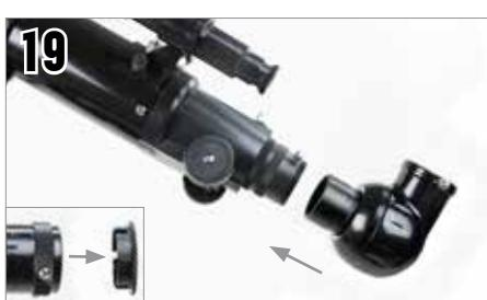
19 Lösen Sie die Schrauben am Fokussierer, damit sie den Innen-durchmesser des Fokussierers nicht behindern. Entfernen Sie die Plastikabdeckung, die das Ende des Fokussierers abdeckt. Setzen Sie den Zenitspiegel in den Fokussierer ein und ziehen die Stellschraube fest.
