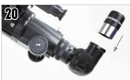
Retirez le cache et insérez l'oculaire de 20 mm dans le renvoi coudé puis serrez les vis de fixation.
