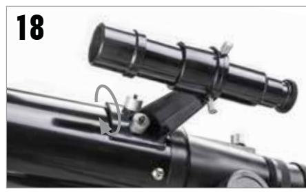
Localizzare il cercatore e rimuovere i tappi in plastica sulla parte anteriore e posteriore della lente. Orientare il cercatore in modo che la lente più grande sia rivolta verso la parte anteriore del tubo come mostrato. Sistemare il cercatore sui fori del tubo e fissarlo mediante i dadi zigrinati.
