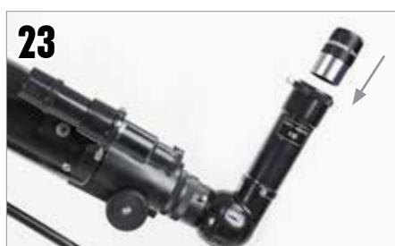
23 Setzen Sie anschließend das Okular in die Barlowlinse ein und ziehen die Stellschrauben fest, um es zu fixieren.
