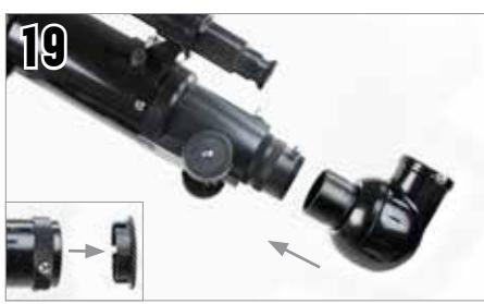
Allentare le viti sul focheggiatore in modo che non ostruiscano il diametro interno del focheggiatore. Rimuovere il tappo di plastica che copre l'estremità del focheggiatore. Inserire la diagonale nel focheggiatore e serrare la vite di regolazione.
