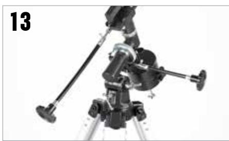
13 Ein Kabel muss an der Rektaszensionsachse und das andere an der Deklinationsachse befestigt werden. Ziehen Sie die Schraube fest, um das Kabel an der richtigen Position zu sichern.
