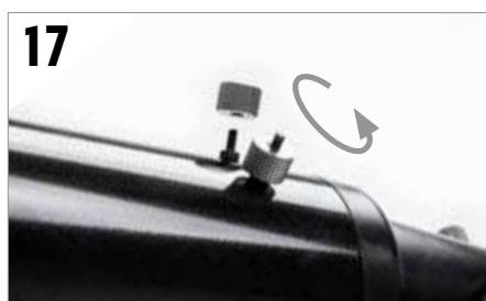
17 Entfernen Sie die Rändelmuttern von den Gewindestangen am Fokussiererende des Teleskopstutzens.
