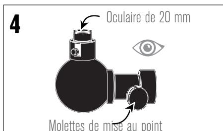
Regardez dans l'oculaire de 20 mm dans le télescope. Faites tourner doucement la molette de mise au point pour ajuster la netteté de l'image.
