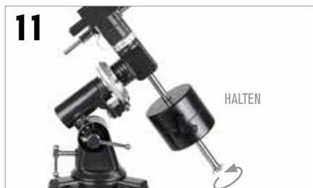
11 HALTEN Halten Sie das Gegengewicht mit einer Hand und richten Sie die Gegengewichtsstange nach der Montierung aus. Drehen Sie mit der anderen Hand die Gegengewichtsstange, bis sie fest sitzt. Ziehen Sie die Gegengewichts-Arretierschrauben fest, um das Gegengewicht in Position zu halten.
