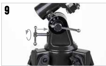
Suchen Sie im Internet oder mit einer Karte den ungefähren Breitengrad Ihres Beobachtungsorts. Schrauben Sie anschließend die Breitengrad-Einstellschraube in die äquatoriale Montierung, bis Ihr Breitengrad auf der Breitengradskala angezeigt wird.
