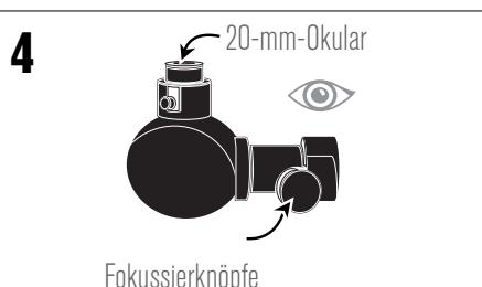
Schauen Sie durch das 20-mm-Okular des Teleskops. Drehen Sie die Fokussierknöpfe langsam, um das Bild scharfzustellen.
