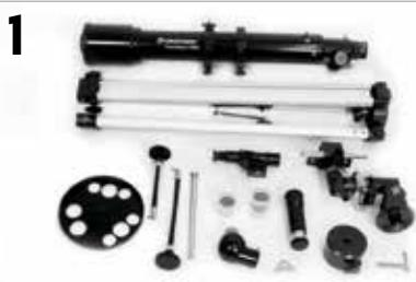
Desembale el telescopio y compruebe que estén presentes todas las piezas. Su PowerSeeker 70EQ incluye: un tubo óptico; trípode; soporte ecuatorial; tornillo de ajuste de latitud; diagonal estelar; 2 oculares; una lente Barlow 3x; localizador; contrapeso de 4lb.; barra de contrapeso; dos cables de control de movimiento lento; y una bandeja de accesorios.
