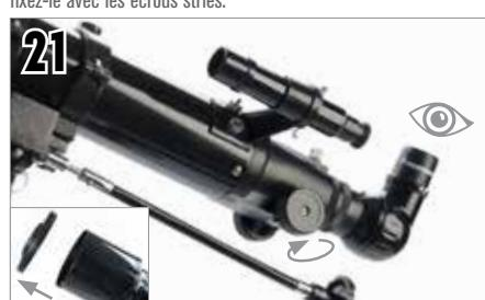
Retirez le capuchon de la lentille de l'avant du télescope. Pour effectuer l'observation, regardez dans l'oculaire comme montré ci-dessus. Faites le point sur l'image en faisant tourner les molettes sous le système de mise au point.
