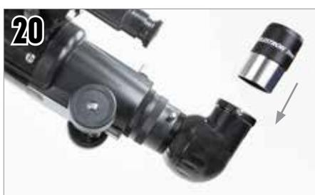
Saque la tapa e introduzca el ocular de 20mm en la diagonal y apriete el tornillo.
