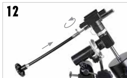
Faites glisser l'extrémité chromée des câbles de mouvement au ralenti dans l'arbre d'entraînement de la monture équatoriale. Veillez à aligner la vis de fixation sur le point plat de l'arbre. Serrez la vis pour fixer en position.
