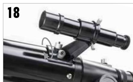
Localice el localizador y saque las tapas de plástico en la parte anterior y posterior de la lente. Oriente el localizador de forma que la lente más grande esté orientada a la parte anterior del tubo como se indica. Ponga el localizador sobre los agujeros en el tubo y apriételo con las roscas estriadas.
