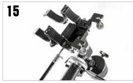
Inserire gli anelli nei fori in cima alla montatura e fissarli utilizzando le manopole rimosse dalla base di ciascun anello.
