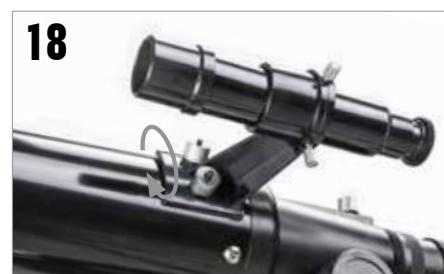
18 Nehmen Sie das Sucherfernrohr und entfernen Sie die Plastikkappen auf der Vorder- und Rückseite des Objektivs. Richten Sie das Sucherfernrohr so aus, dass die größere Linse wie hier gezeigt zur Vorderseite des Tubus zeigt. Setzen Sie das Sucherfernrohr auf die Löcher im Tubus und ziehen es mit den Rändelmuttern fest.
