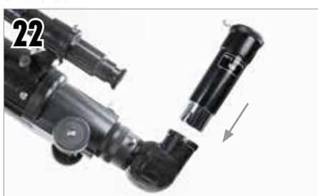
22 Sie können die mitgelieferte 3x Barlowlinse für eine zusätzliche Vergrößerung verwenden. Stecken Sie die Barlowlinse anstelle des Okulars in den Fokussierer. Entfernen Sie die Kappe von der Barlowlinse.
