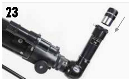
Quindi, inserire l'oculare nella lente di Barlow e serrare le viti di regolazione per fissarlo in posizione.
