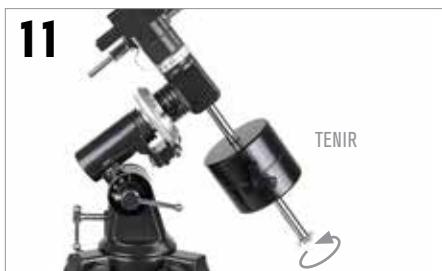
En tenant le contrepoids d'une main, alignez la barre de contrepoids avec la monture. De l'autre main, faites tourner la barre de contrepoids jusqu'à ce qu'elle soit complètement installée. Serrez la vis de fixation du contrepoids pour maintenir le contrepoids en place.
