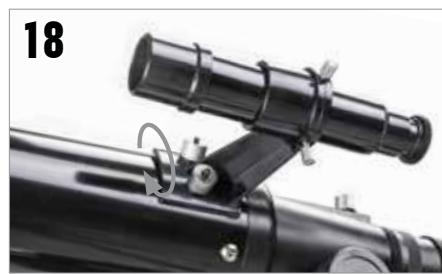
Identifiez le chercheur et retirez les capuchons de plastiques de l'avant et de l'arrière de la lentille. Orientez le chercheur de manière à ce que la lentille de plus grande taille soit orientée vers l'avant du tube, comme illustré. Placez le chercheur sur les trous du tube et fixez-le avec les écrous striés.
