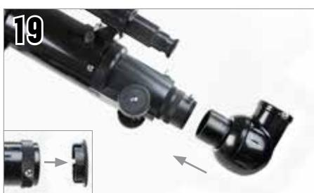
Afloje los tornillos del enfoque de forma que no obstruyan el diámetro interno del enfoque. Saque la tapa de plástico que cubre el extremo del enfoque. Inserte la diagonal en el enfoque y apriete el tornillo.
