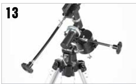
El cable debería conectarse al eje de ascension derecha, y el otro cable de conecta al eje de declinación. Apriete el tornillo para asegurar el cable en posición.
