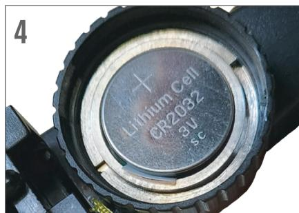
4. Vuelva a poner la batería en el compartimiento de batería con el lado positivo (+) orientado hacia arriba.
