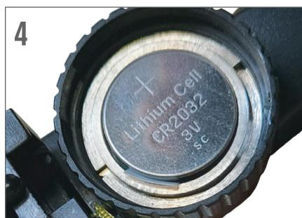
**4.** Legen Sie die Batterie mit der positiven (+) Seite nach oben wieder in das Batteriefach ein.
