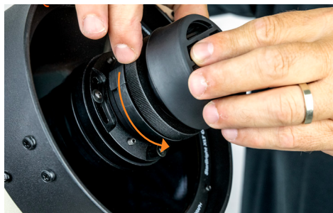
Fig. 2: Per rimuovere la fotocamera Origin-178C da Origin, svitare prima l'anello di fissaggio.
