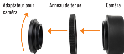
Fig. 4: Retirez l'adaptateur et la bague de retenue de la caméra en dévissant l'adaptateur.
