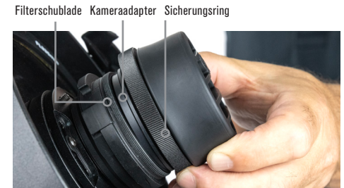
Abb. 8: Setzen Sie den Kameraadapter auf die freiliegende Filterschublade und ziehen dann den Sicherungsring fest.
