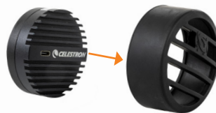
Abb. 5: Entfernen Sie die Gummiabdeckung von der Kamera. Sie können sie einfach abziehen.
