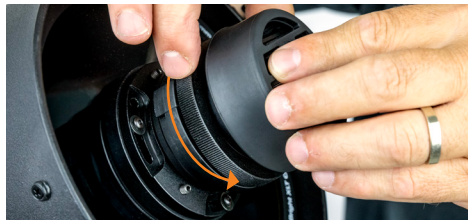
Fig. 2: Pour retirer la caméra Origin-178C de l'Origin, dévissez d'abord la bague de retenue.
