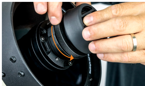
Fig. 2: Para retirar la cámara Origin-178C de Origin, desenrosque primero la arandela de retención.
