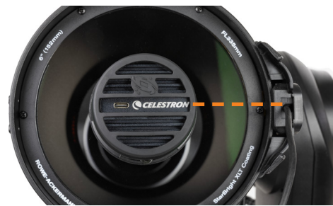
Fig. 9: Consigliamo di orientare la fotocamera come mostrato, con il sensore parallelo al logo Celestron sulla parte anteriore della fotocamera. In questo modo, il sensore viene posizionato perpendicolarmente all'asse di altitudine di Origin.
