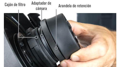
Fig. 8: Coloque el adaptador de la cámara sobre el cajón de filtro expuesto y apriete la arandela de retención.
